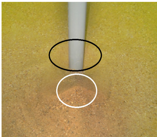
RAJAH 4. Proses-proses yang berlaku selepas masa T=60 minit bagi model tiang bersilinder bersaiz 3.5 cm. Bulatan hitam dan putih masing-masing mewakili lingkungan kerokan dan pempadapan sedimen. Arah aliran air ditunjukkan melalui anak panah
