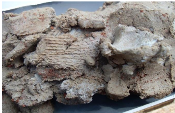
Foto 13. Kerja-kerja penggerudian sedang dijalankan (kiri), Hasil penggerudian menjumpai enapan aluvium dengan tanah lempung yang berwarna kelabu muda (kanan)
