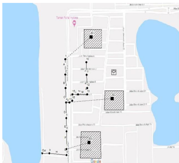
RAJAH 1. Kawasan kajian yang telah dimodelkan menggunakan perisian SWMM (Nombor merujuk kepada lurang, manakala simbol huruf merujuk kepada paip)
