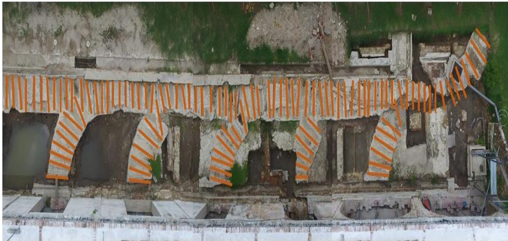
Rajah 8. Lakaran bentuk trek troli yang dibina menggunakan konkrit bersama kayu pelandas ( sleepers ).
