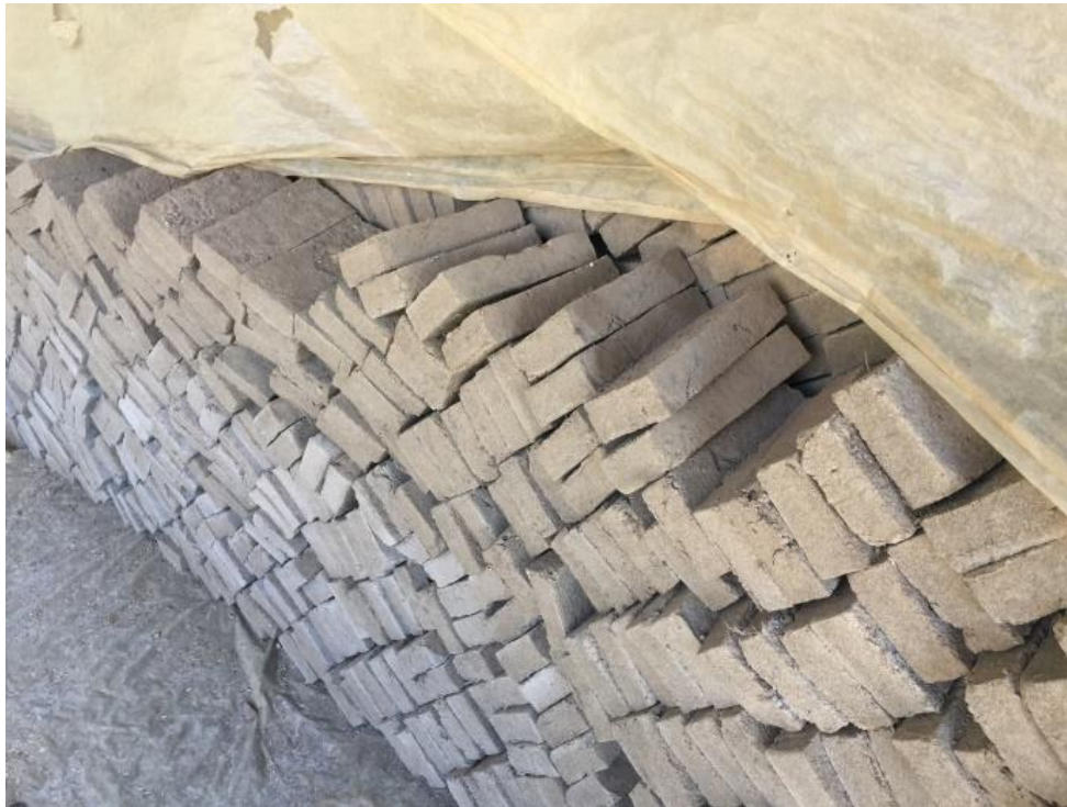
Gambar 10. Susunan bata sebelum dibakar
