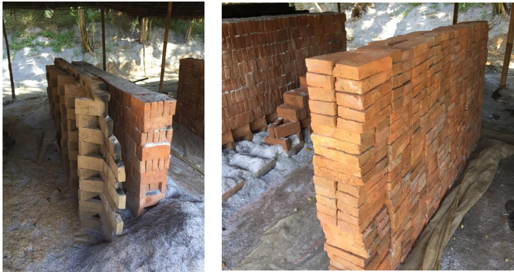
Gambar 8. Susunan bata setelah dibakar
