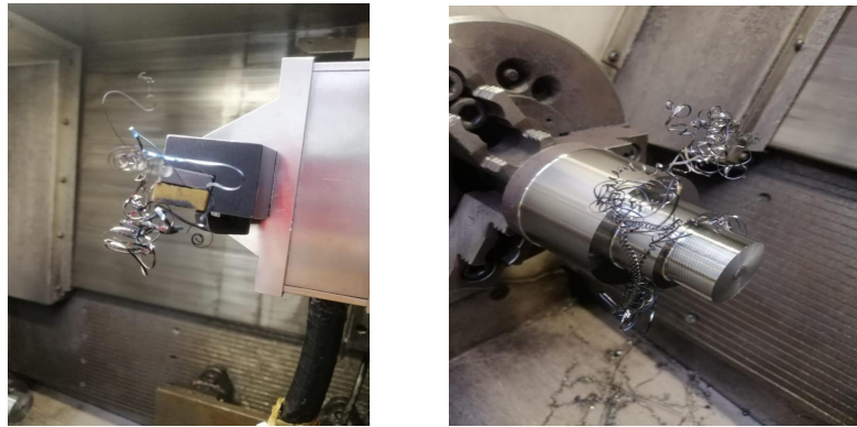
RAJAH 4. Serpihan yang melingkar di sekitar bahan kerja dan mata alat semasa pemesinan dalam keadaan kering S45C
