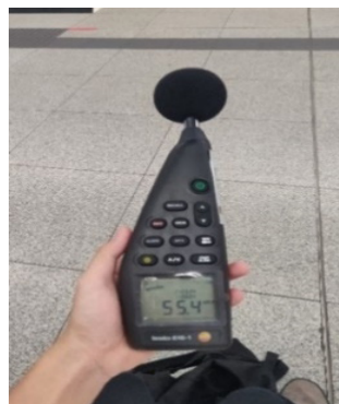
RAJAH 8. Instrumen meter desibel yang digunakan dalam pengukuran kadar bunyi di stesen MRT Cochrane.
