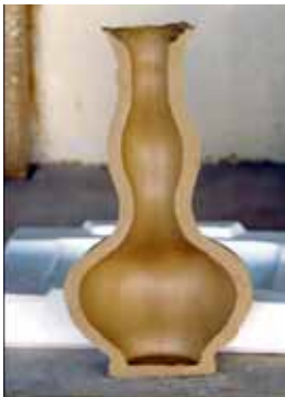
GAMBAR 6: Bahagian dalam labu acu yang lebih licin dan ketebalan lapisan yang sekata.
